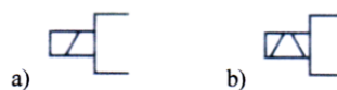
Rys. 4. Sterowanie elektryczne a) elektromagnes z jedną cewką, b) elektromagnes z dwoma cewkami działającymi przeciwnie
