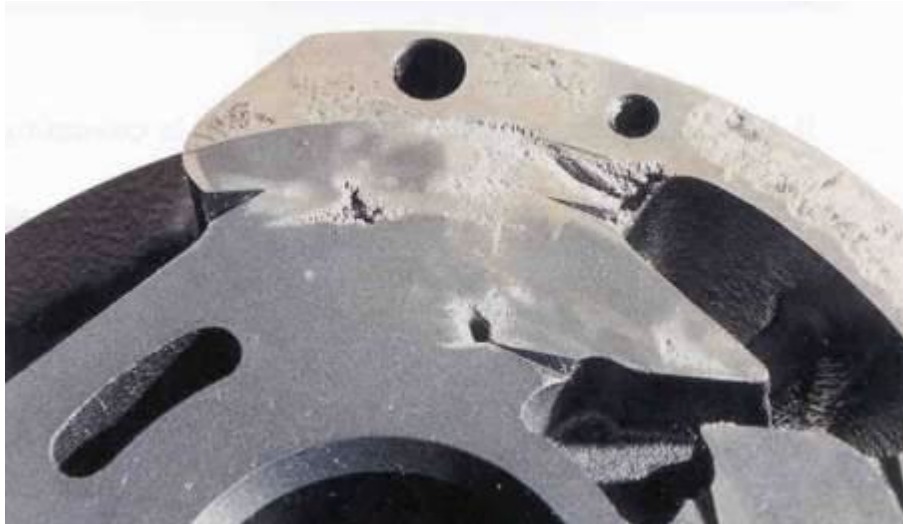
Rys. 7. Przykład zużycia (erozji kawitacyjnej) płyty bocznej pompy łopatkowej. [4]
